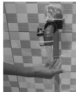
Gambar 5. Pengujian Keran Air Otomatis untuk jarak dekat
