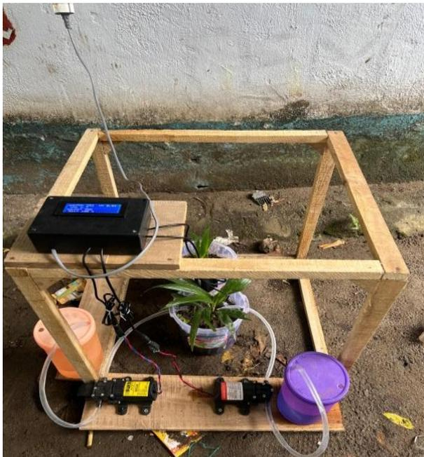
Gambar 5. Prototipe Sistem Penyiraman dan Pemupukan pada Pembibitan Kelapa Sawit
